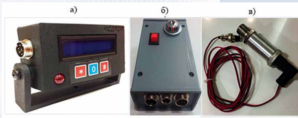
Прототип интеллектуальной системы диагностики тормозной сети поезда а – блок индикации; б – блок коммутации; в – датчик давления
