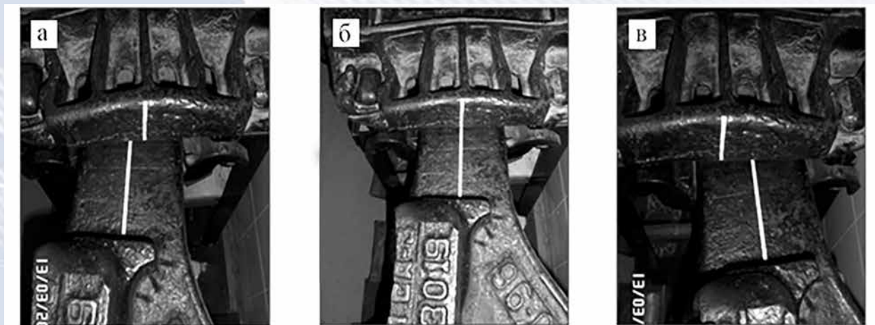
Способ контроля технического состояния автосцепки при заклинивании: а) левый перекося; б) симметрия (нормальное положение); в) правый перекося
