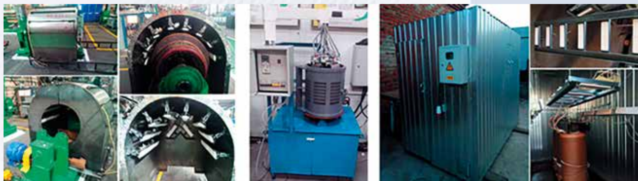
Аппаратные комплексы для упрочнения полимерной изоляции электрооборудования тепловым излучением (якорей ТЭД, вспомогательных машин, трансформаторов)
