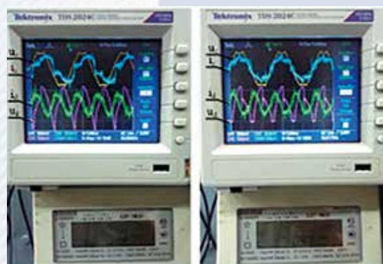
Осциллограммы и значения коэффициентов мощности тиристорного (слева) и транзисторного (справа) ВИП в режиме тяги на примере 2,5 зоны
