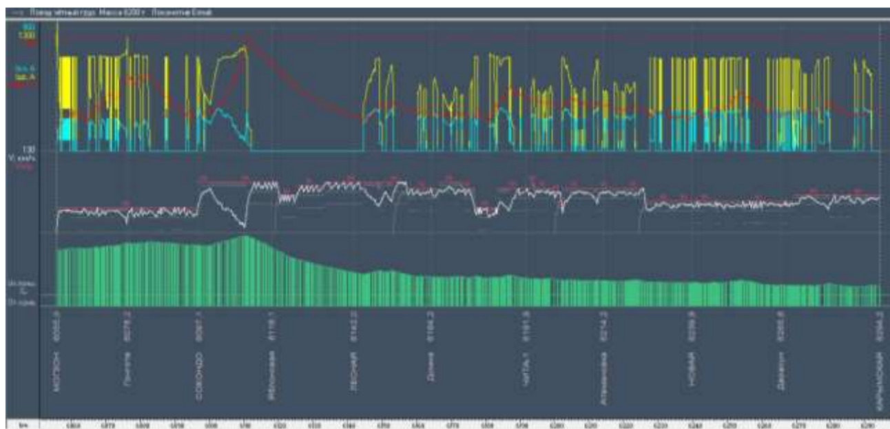
Рис. 2. Тяговые расчеты локомотива Ермак массой 6200 т. выполнены с учетом четного направления без рекуперативного торможения
