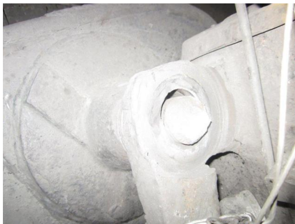
Рис. 1 – Излом головки болта крепления кожуха зубчатой передачи
