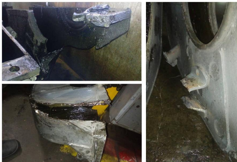
Рис. 8 – Основные изломы кожуха зубчатой передачи электровоза серии 2(3)ЭС5К
