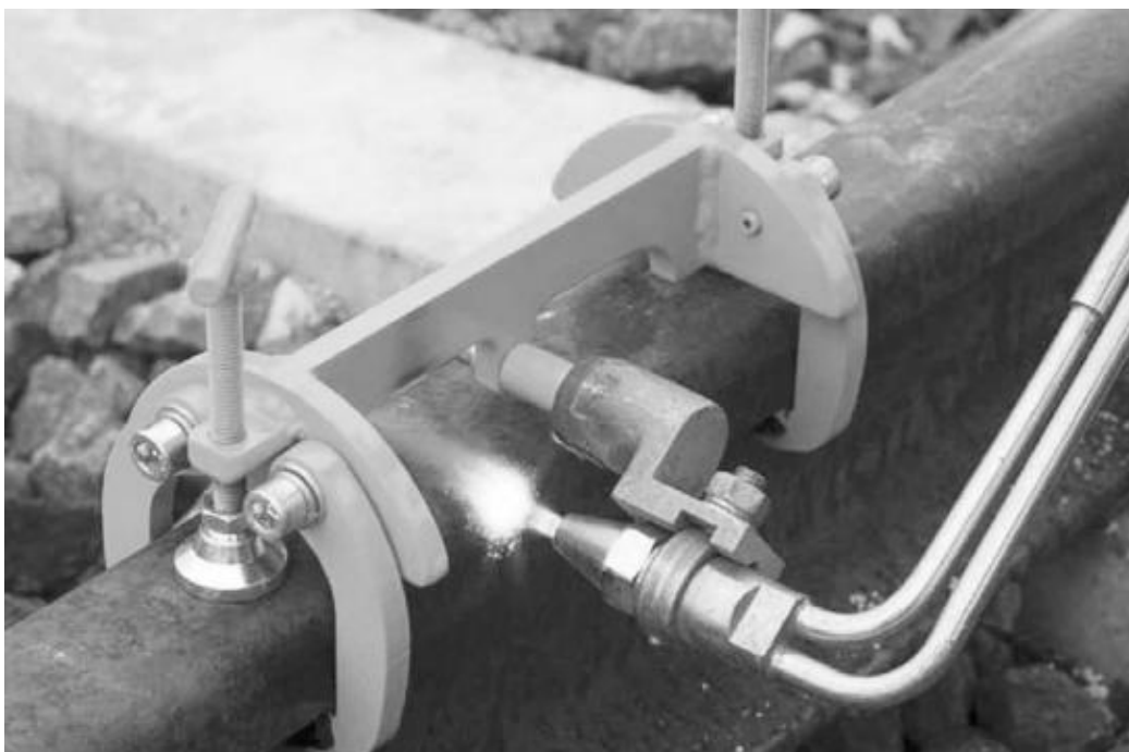
Рис. 2. Газовая резка резаком струёй режущего кислорода
