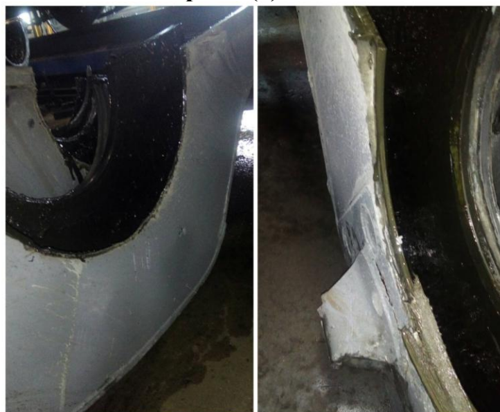
Рис. 9 – Основные изломы кожуха зубчатой передачи электровоза серии 2(3)ЭС5К
