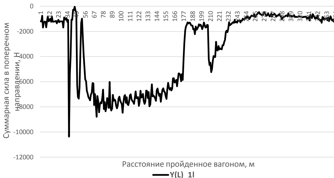
Рис. 3 – Диаграмма прохода грузового полувагона по пути с отклонениями ширины рельсовой колеи до 1549 м. Y(L)_11 – суммарная сила в поперечном направлении, возникающая по наружной рельсовой нити
