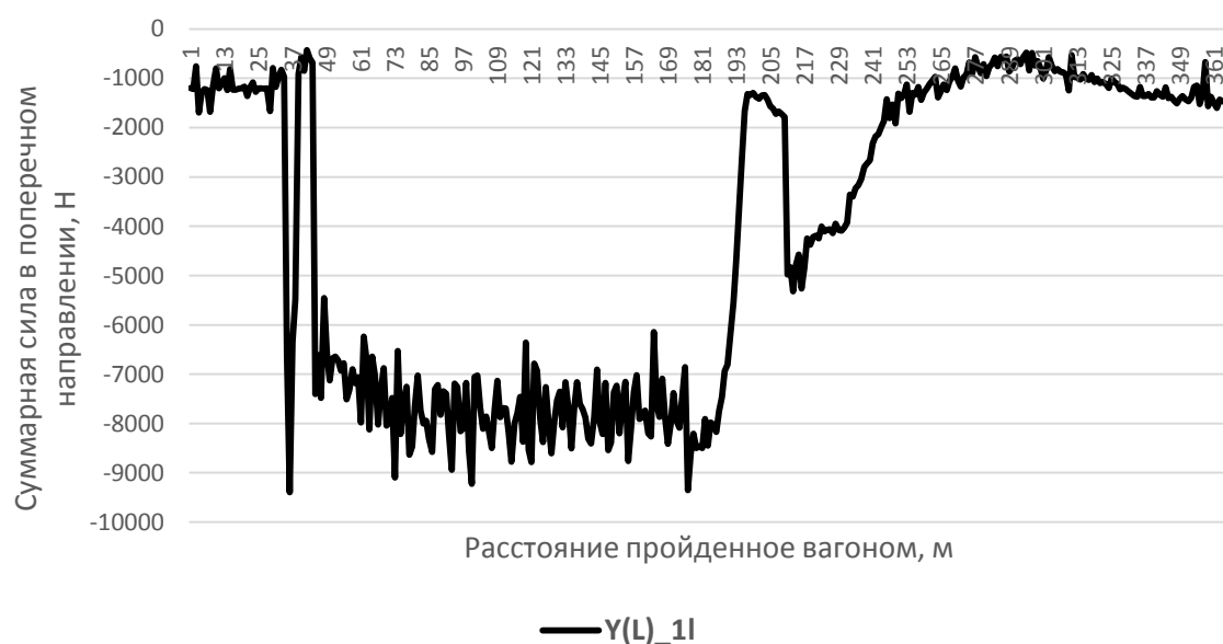
Рис. 2 – Диаграмма прохода грузового полувагона по пути с номинальной шириной рельсовой колеи 1520 м. Y(L)_11 – суммарная сила в поперечном направлении, возникающая по наружной рельсовой нити
