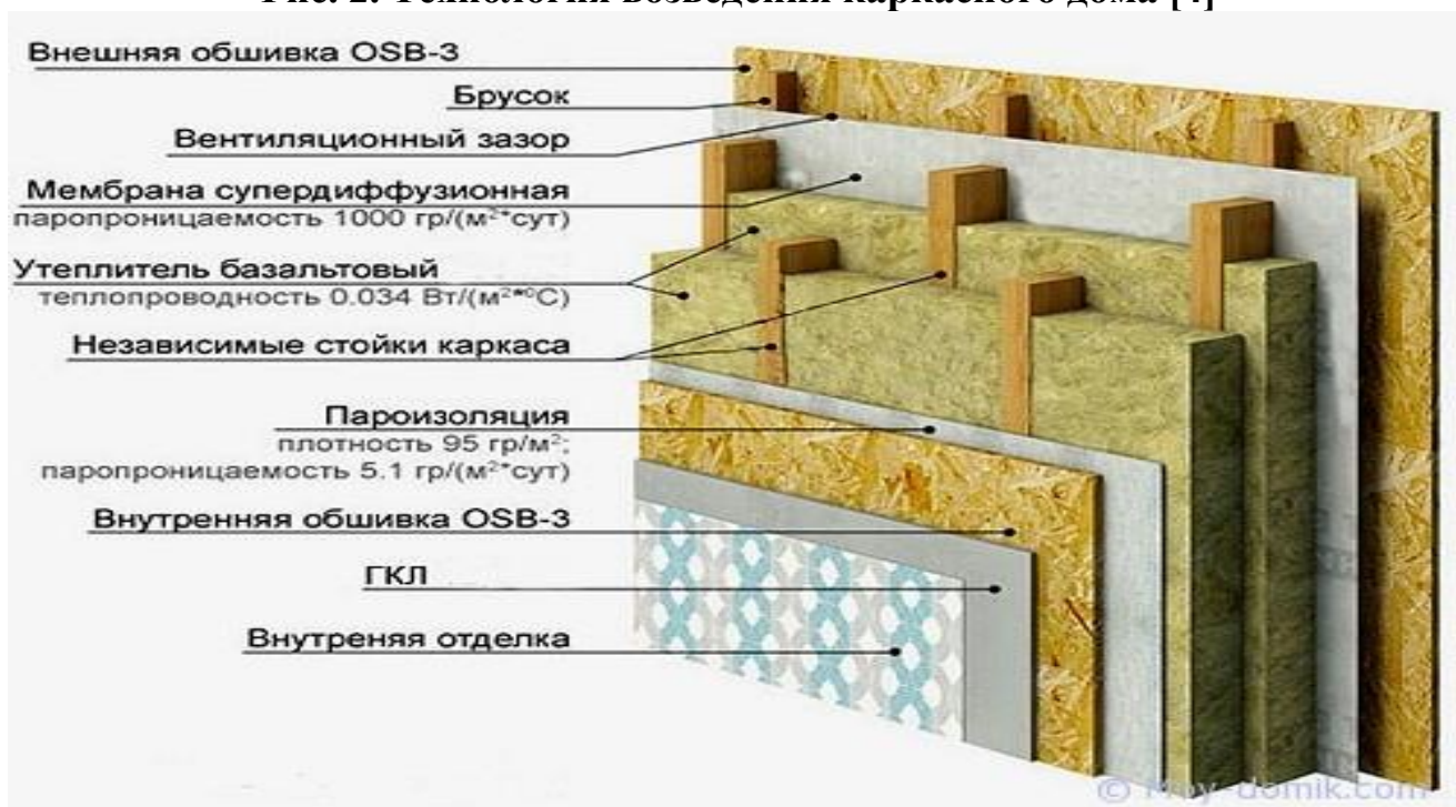
Рис. 3. Стена каркасного дома в разрезе [5]
