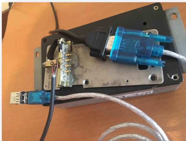
Рис. 5 – Блок записи данных с долговременной энергонезависимой электронной памятью БР-У с USB-накопителем
