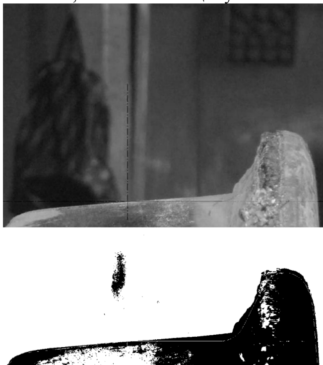
Рис. 2. Полученное изображение профиля колеса и конвертированное в монохромное изображение с наложением линии эталонного профиля
