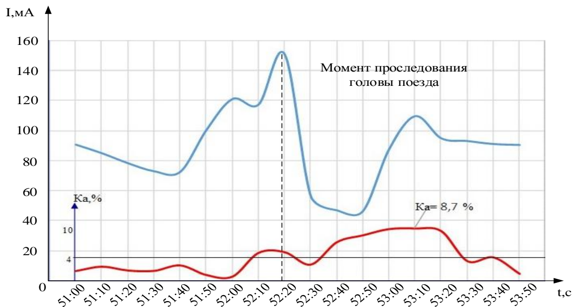
Рис. 2 – Величина обратного тягового тока при прохождении по рельсовой цепи поезда весом 1705 тонн
