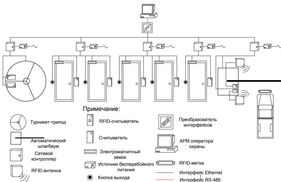
Рис. 1 Система контроля и управления доступом на объекте РЦС
