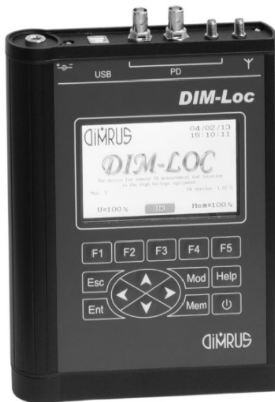
Рис. 2. Универсальный прибор для измерения частичных разрядов
