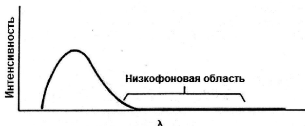
Рис. 2б. Спектр излучения рентгеновской трубки после прохождения через фильтр
