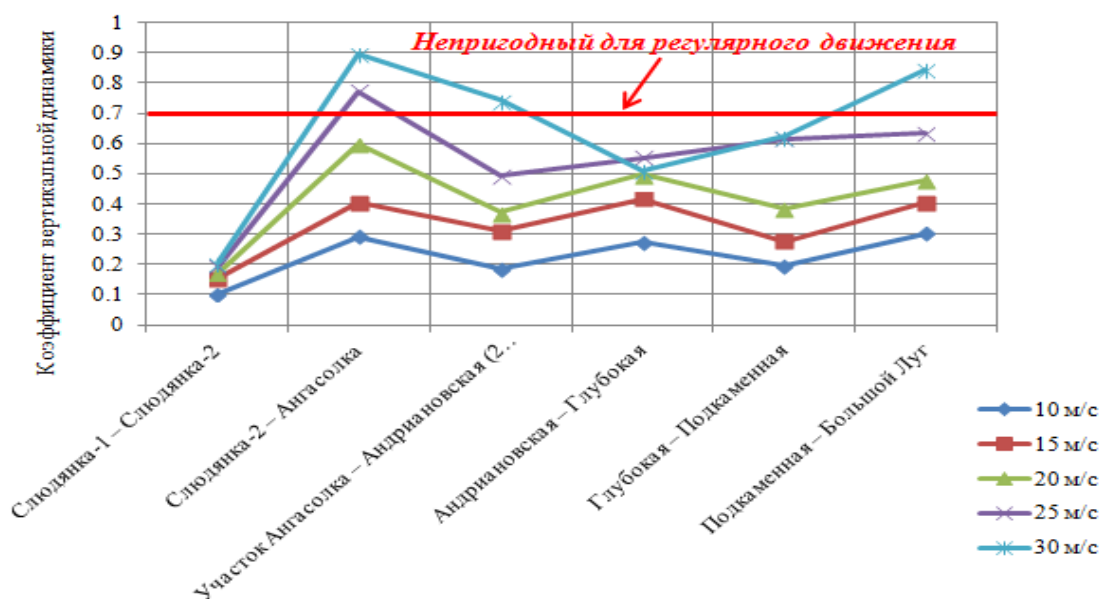
Рис. 5. Изменение коэффициента вертикальной динамики при движении по второму пути (направление на запад)
