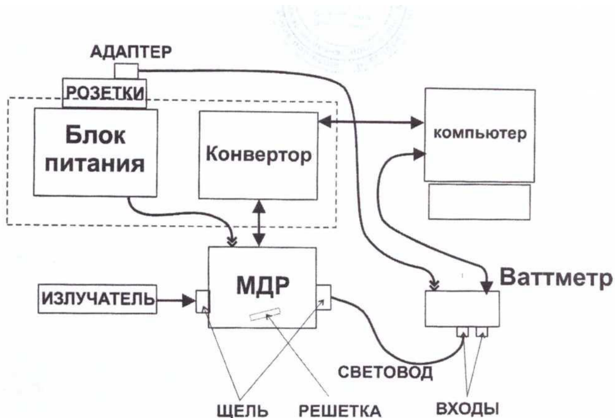
Рис. 4. Блок-схема установки при измерении длины волны источников оптического излучения
