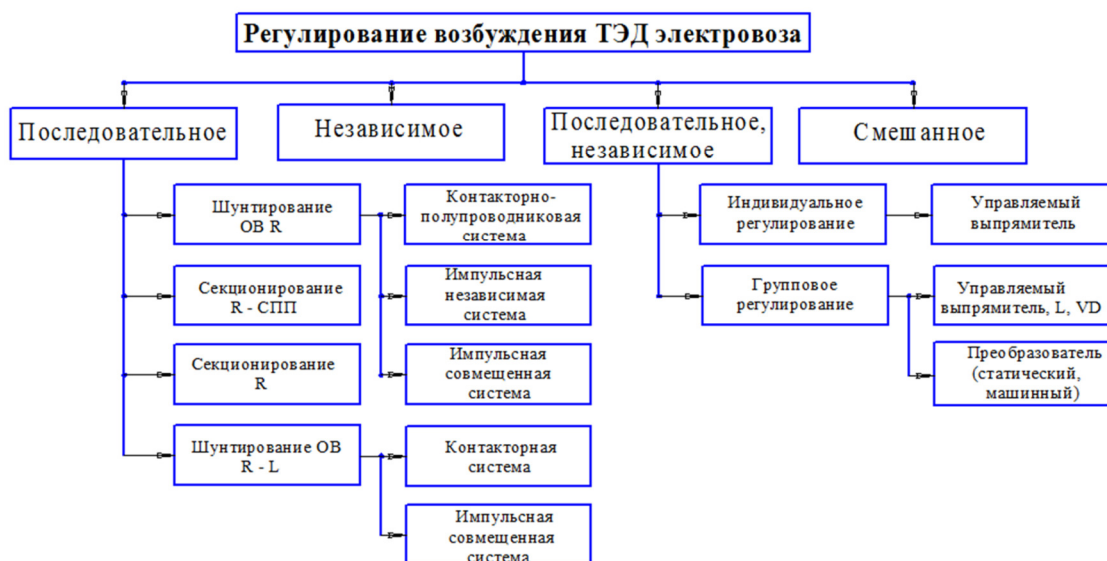
Рис. 1. Классификация систем регулирования возбуждения ТЭД
