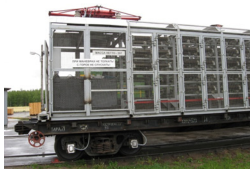
Рис. 1 – Нагрузочное устройство контактной сети для вагона ВИКС
