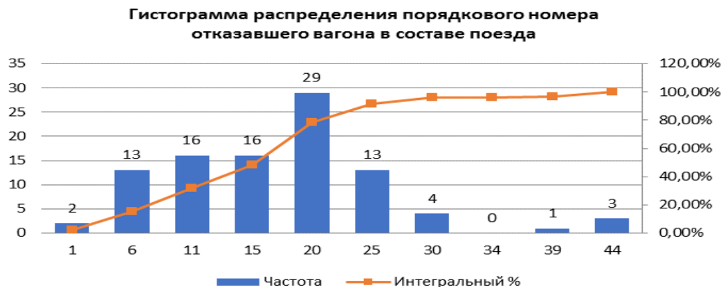
Рис. 6. Гистограмма распределения порядкового номера отказавшего воздухораспределителя вагона в составе поезда
