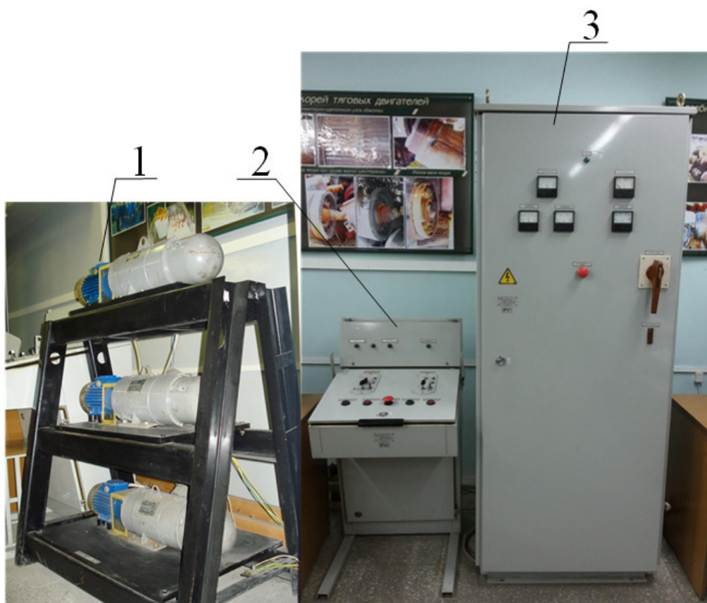
1 – Силовой агрегат; 2 – Пульт управления; 3 – Шкаф управления.
