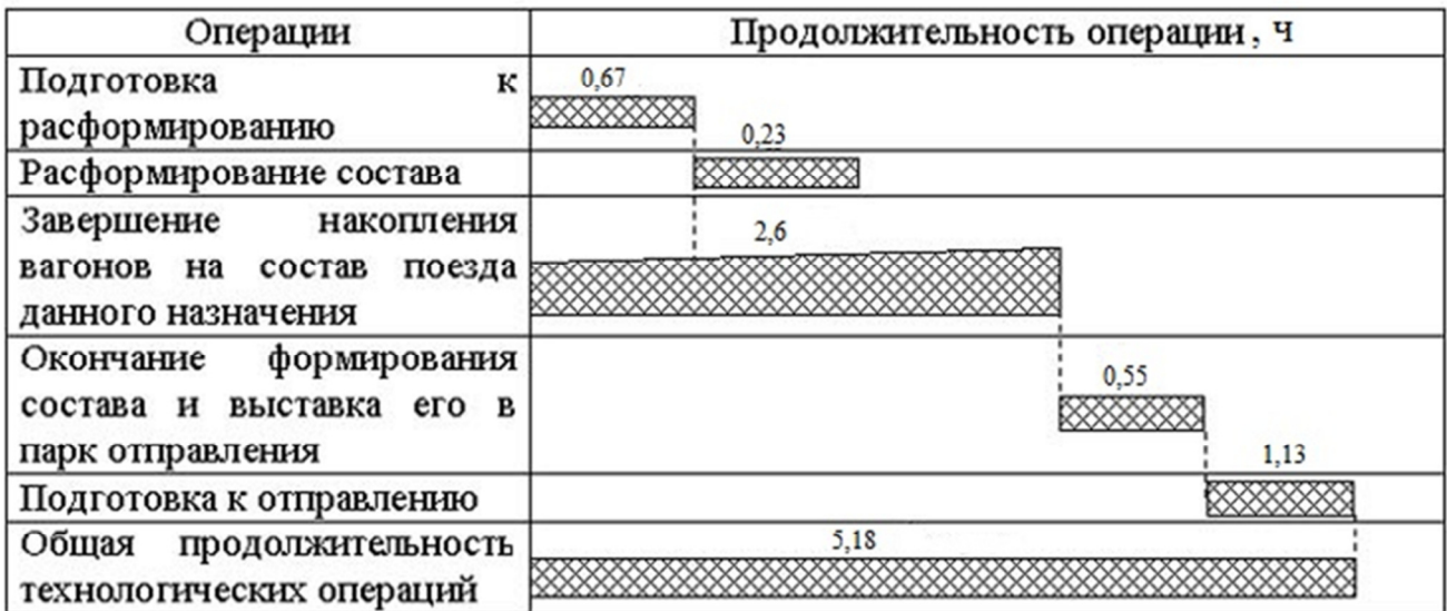
Рис. 3. Укрупнённый технологический график переработки транзитного вагонопотока
