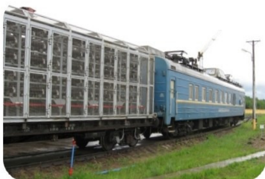
Рис. 1 – Нагрузочное устройство контактной сети для вагона ВИКС
