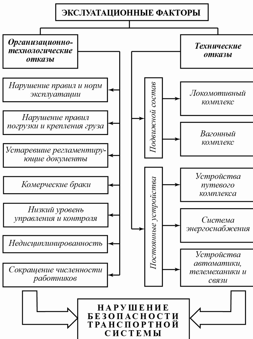
Рис. 2. Эксплуатационные факторы, воздействующие на состояние безопасности железнодорожной транспортной системы
