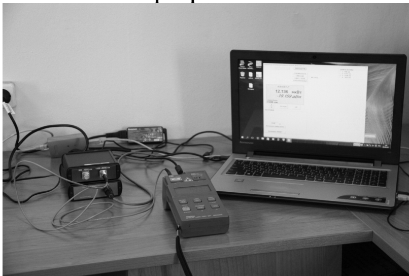
Рис. 3. Схема проверки стабильности источника
