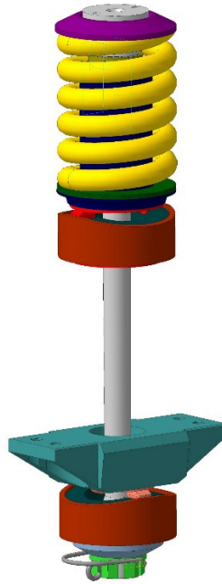
Рис. 1. 3d модель узла люечного подвешивания электровоза ВЛ85
