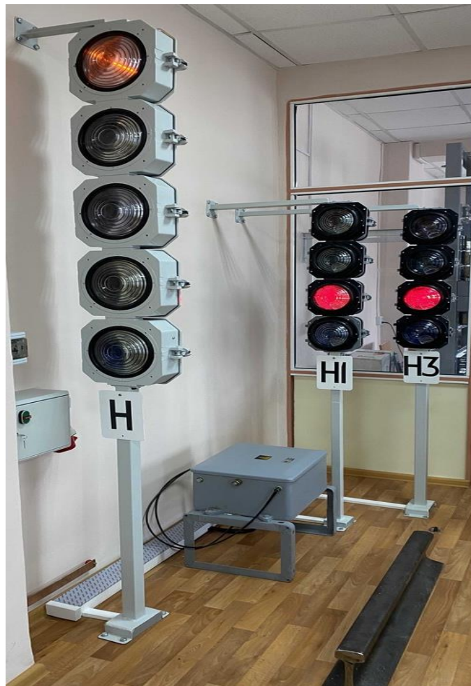
Рисунок 1 – Светофоры, и их показания при приеме поезда на главный путь с остановкой
