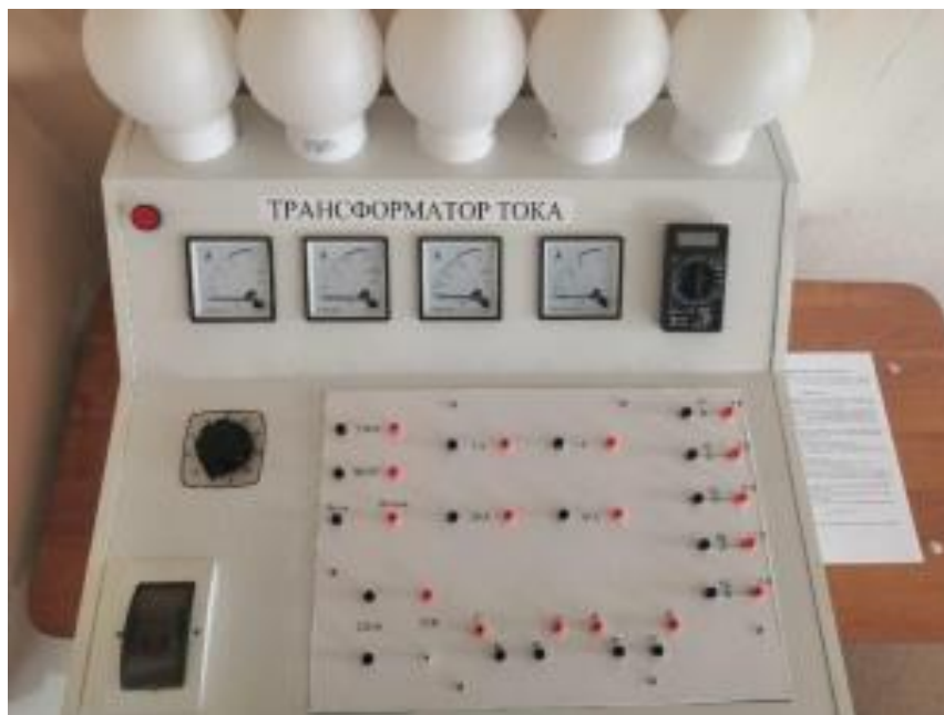
Рисунок 1 – Стенд трансформатор тока
