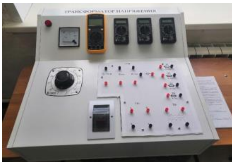
Рисунок 2 – Стенд трансформатор напряжения
