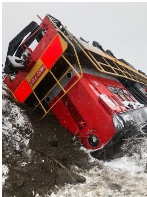
Рисунок 3 – Опрокидывание грузового локомотива
