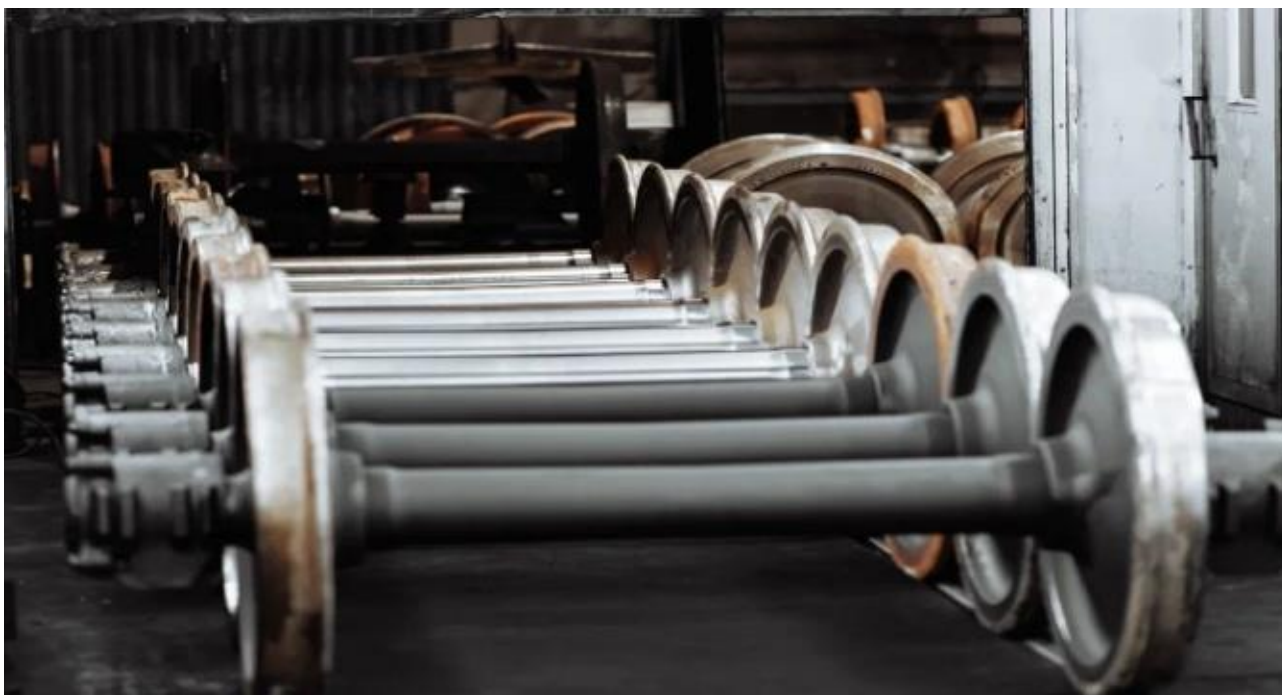
Рисунок 1 – Отремонтированные колесные пары
