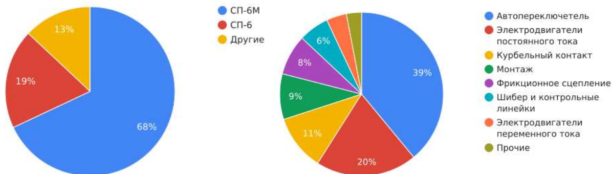
Рисунок 2 – Диаграммы распределения числа стрелочных электроприводов различных типов на железных дорогах РФ и распределения видов отказов стрелочных электроприводов типа СП-6 (СП-6М)
