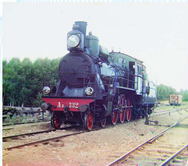
Паровоз "Компаунд" с пароперегревателем «Шмидта». 1910 г.
