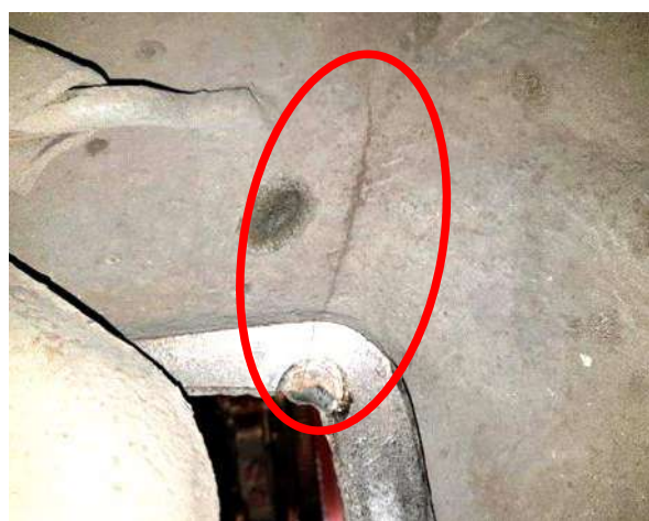
Рис. 3. Трещины в остове тягового электродвигателя НБ-514:
