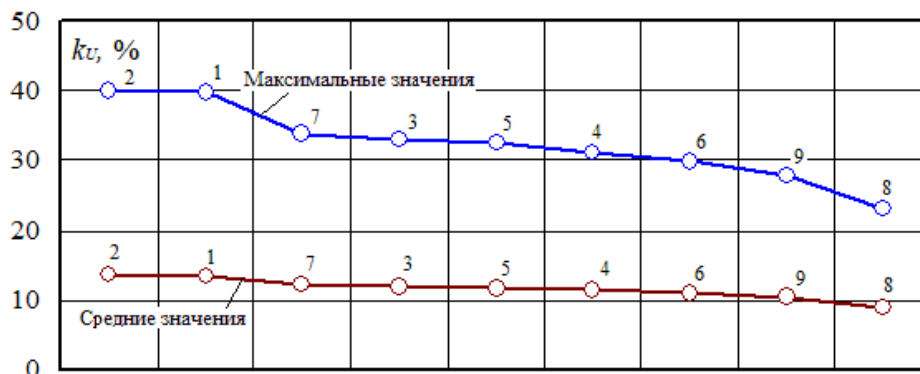
Рис. 17. Суммарные коэффициенты гармоник на вводе 27,5 кВ тяговой подстанции №4 (цифровые обозначения соответствуют рис. 7)
