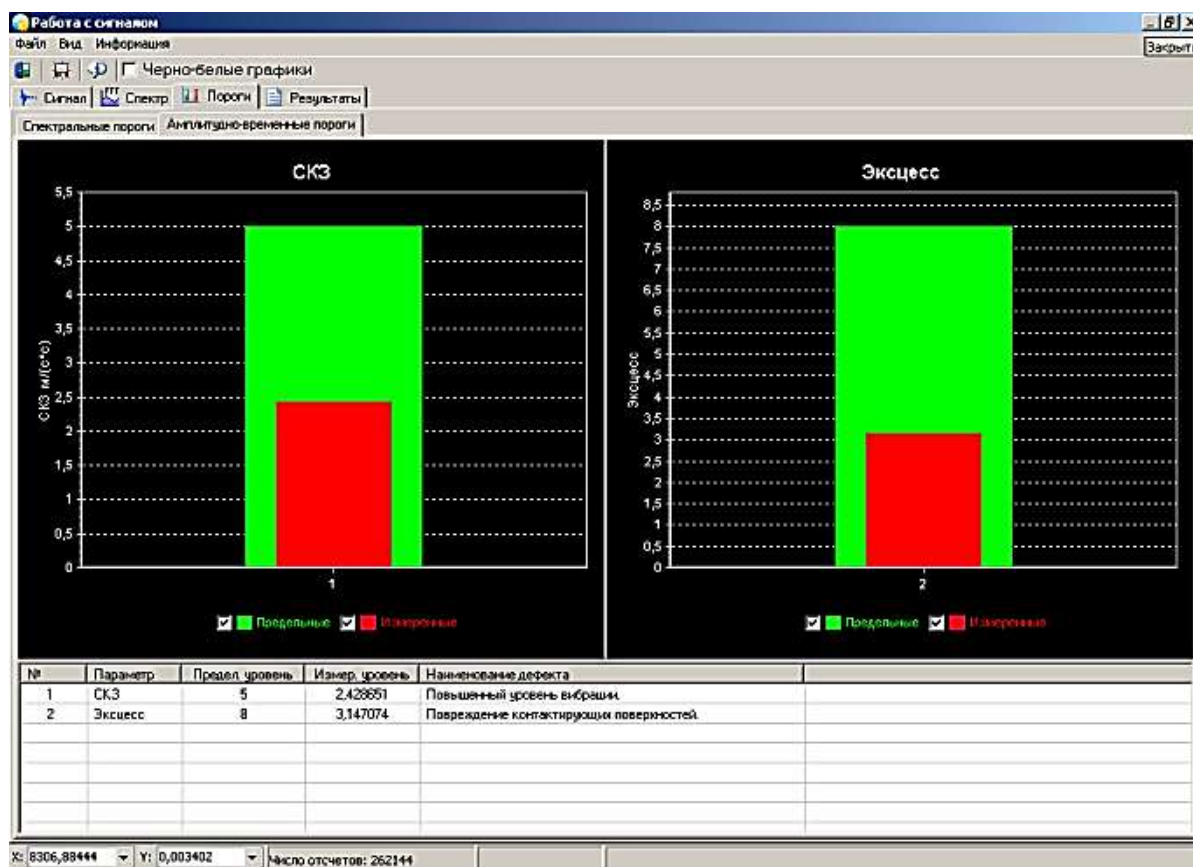
Рис. 3. Пороги для среднеквадратичного значения и эксцесса неисправной буксы
