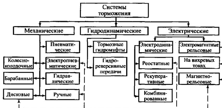
Рис. 2. Классификация систем торможения подвижного состава
