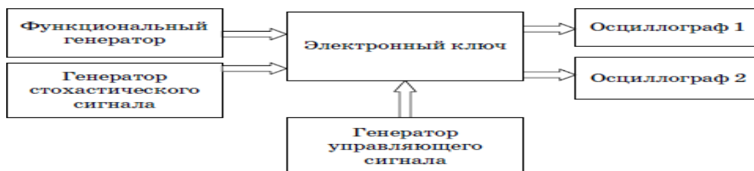
Рис. 6.4. Структурная схема исследования процесса дискретизации и квантования сигналов
