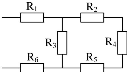
2. Методом эквивалентных преобразований определить токи  $I_1$ ,  $I_2$ ,  $I_3$  в цепи и составить баланс мощностей, если известно:  $R_1 = 12 \text{ Ом}$ ,  $R_2 = 20 \text{ Ом}$ ,  $R_3 = 30 \text{ Ом}$ ,  $U = 120 \text{ В}$ .
