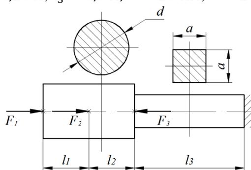
7. С помощью диаграммы растяжения стали (Ст.3) квадратного поперечного сечения определить размеры рабочей части образца ( $a_0$ ,  $l_0$ ) и предел текучести, если известно:  $\sigma_B = 320$  МПа;  $E = 210000$  МПа.
