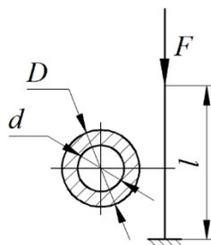
3. Для заданной стальной балки ( $E = 210 \text{ ГПа}$ ) определить динамическое напряжение и перемещение в точке падения груза весом  $G$  с высоты  $h$
