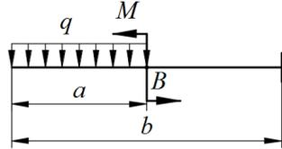
5. Для заданной балки методом Мора-Верещагина определить прогиб в точке  $B$ .
