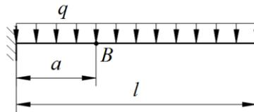
6. Для заданной балки построить эпюры изгибающих моментов в двух плоскостях и эпюру нормальных напряжений в опасном сечении
