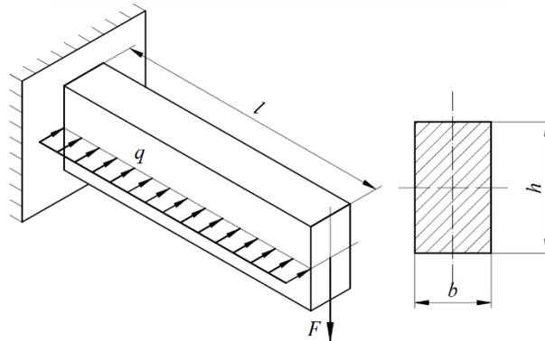
7. Для заданной стальной балки ( $E = 210 \text{ ГПа}$ ) определить динамическое напряжение и перемещение в точке установки двигателя массой  $m_d$ , работающего с угловой скоростью  $\omega$  и создающего центробежную силу  $F$ .
