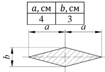
3. Для внецентренно сжатой стойки построить эпюру напряжений
