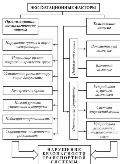
**Рисунок 1.3. Эксплуатационные факторы, воздействующие на состояние безопасности ЖДТС**
