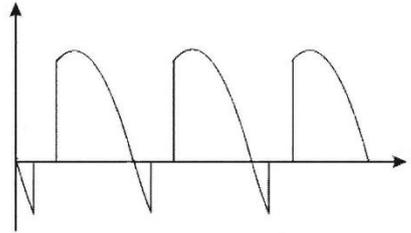
осциллограмма напряжения на нагрузке
