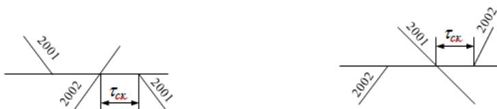
Расположение грузовых поездов на станции при интервале скрещения
