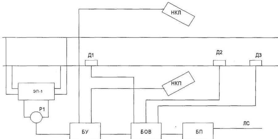
Состав системы: 1) ЭП-1 – электронная педаль; 2) Р1 – путевое реле; 3) Д1; 4) Д2; 5) Д3 – датчики счёта осей; 6) НКП – напольная камера правая; 7) НКЛ – напольная камера левая; 8) БУ – блок управления; 9) БОВ – блок отметчик вагонов; 10) БП – блок передачи сообщений; 11) ЛС – линия связи.
