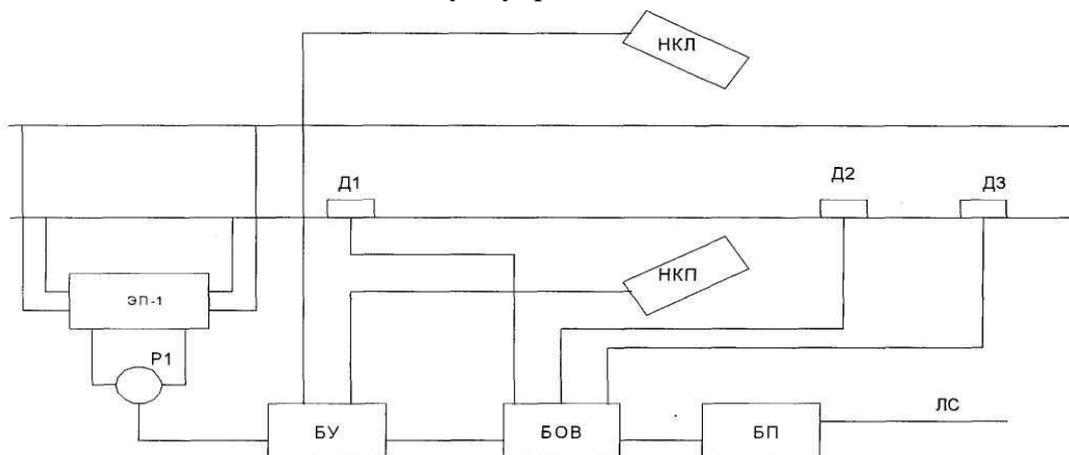
Состав системы: 1) ЭП-1 – электронная педаль; 2) Р1 – путевое реле; 3) Д1; 4) Д2; 5) Д3 – датчики счёта осей; 6) НКП – напольная камера правая; 7) НКЛ – напольная камера левая; 8) БУ – блок управления; 9) БОВ – блок отметчик вагонов; 10) БП – блок передачи сообщений; 11) ЛС – линия связи.
