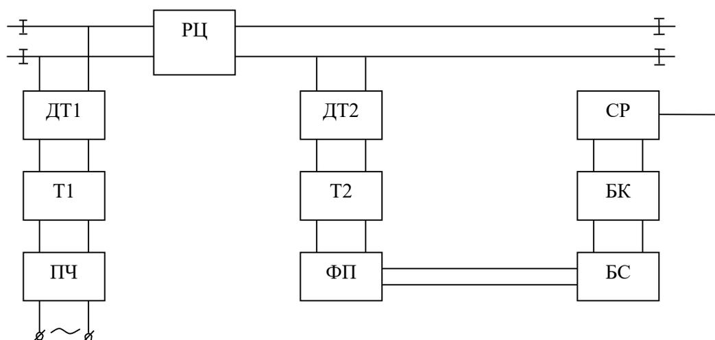
Состав системы: 1) ПЧ – преобразователь частоты; 2) Т1 – входной трансформатор; 3) ДТ1 – входной дроссель-трансформатор; 4) РЦ – рельсовая цепь; 5) ДТ2 – выходной дроссель-трансформатор; 6) Т2 – выходной трансформатор; 7) ФП – фильтр выходной платы; 8) БС – блок сигналов; 9) БК – блок кодов; 10) СР – сигнальное реле.
