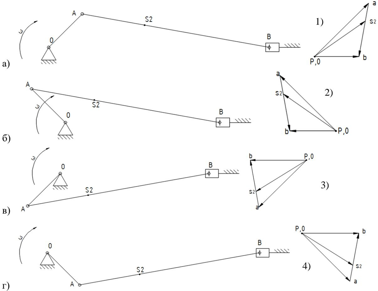
12. На рисунке показаны план положений и план ускорений шарнирного четырехзвенного механизма. Определить касательное ускорение точки В относительно точки А. (400)
