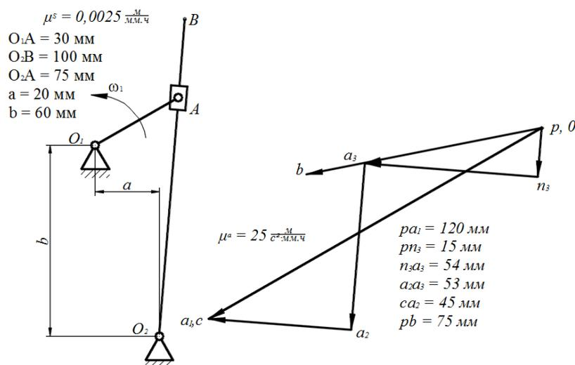
6 Определить величину момента сил инерции шатуна (момент инерции шатуна относительно центра масс 0,1 кг·м<sup>2</sup>).
