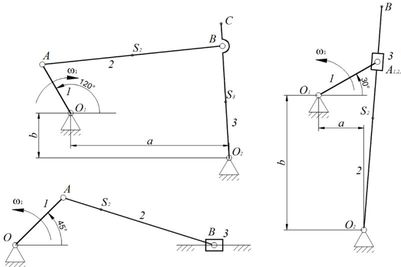
3. Для заданного положения одного из представленных механизмов построить план ускорений и определить ускорения всех точек звеньев механизма, обозначенных на схеме. Размеры звеньев выдаются преподавателем. В кулиском механизме вектор относительной скорости направлен из точки  $O_2$  в точку  $B$ .
