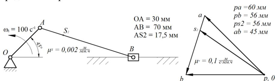
2 На рисунке показаны план положений и план ускорений шарнирного четырехзвенного механизма. Определить касательное ускорение точки В относительно точки А.
