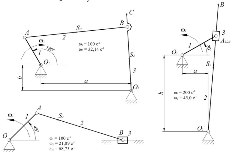
4 Для механизма в заданном положении определить реакции в кинематических парах последней группы Ассур построением плана сил. Размеры звеньев и их инерционные характеристики выдаются преподавателем.
