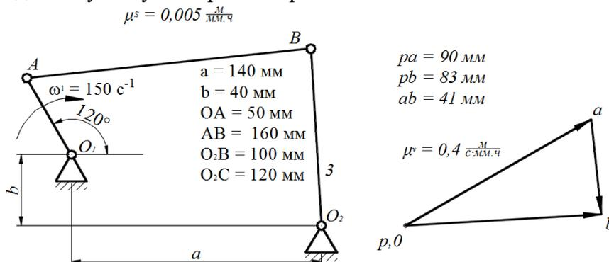
5 На рисунке показаны план положений и план скоростей шарнирного четырехзвенного механизма. Определить угловое ускорение кулисы
