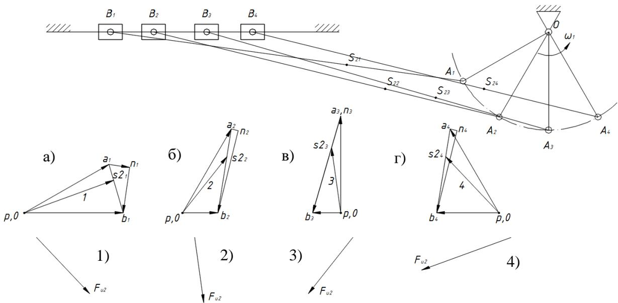
15. Определить величину силы инерции шатуна (масса шатуна 4,0 кг). (20500)
