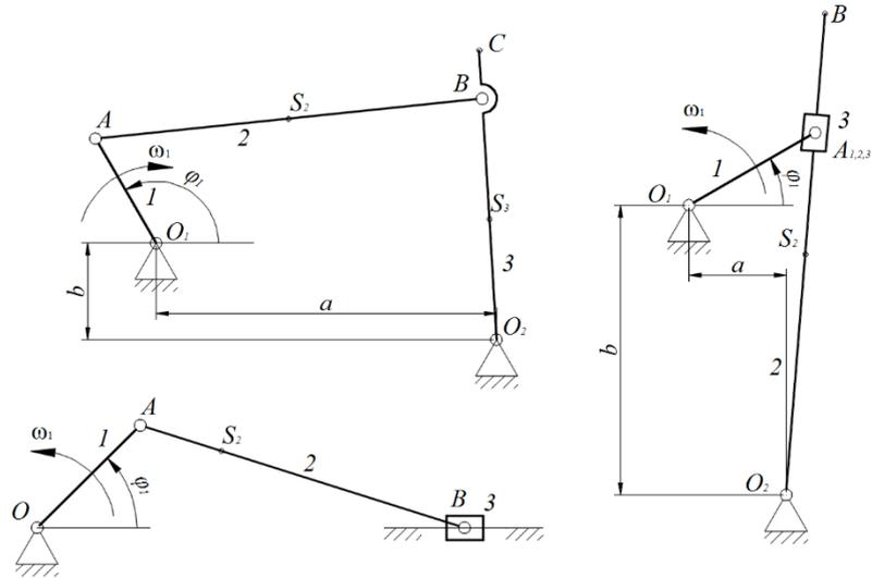
2. Для заданного положения одного из представленных механизмов построить план скоростей и определить скорости всех точек звеньев механизма, обозначенных на схеме. Размеры звеньев и угловая скорость кривошипа выдаются преподавателем.
