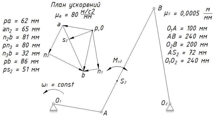
7 На рисунке показаны план положений и план скоростей шарнирного четырехзвенного механизма. Определить касательное ускорение точки В относительно точки O2.
