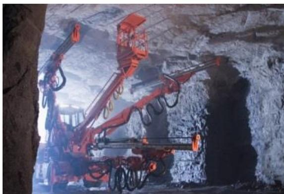
Комбайн для разработки породы, породопогрузочная машина, **буровая рама**
