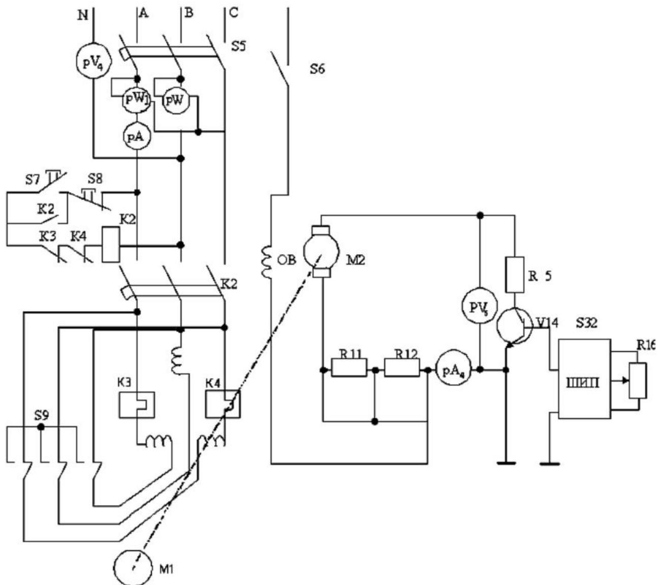
По результатам измерений построить характеристику холостого хода и внешнюю характеристику генератора, по внешней характеристике определить процентное изменение напряжения генератора.
