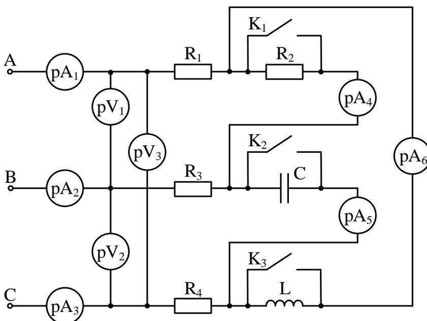
Для каждого опыта определить сопротивление фаз нагрузки, активную мощность всей цепи при изменении характера нагрузки, для каждого режима построить векторную диаграмму токов, совмещённую с векторной диаграммой напряжений.
