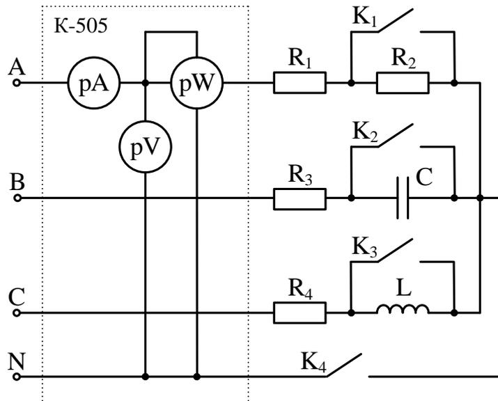
Для каждого опыта определить сопротивление фаз нагрузки, активную и реактивную мощности всей цепи при изменении характера нагрузки, для каждого режима построить векторную диаграмму токов, совмещённую с векторной диаграммой напряжений.
