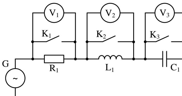
По результатам измерений и вычислений построить векторные диаграммы токов и напряжений для каждого опыта, а также графики зависимостей  $I(f)$ ,  $\cos \varphi(f)$ ,  $U_R(f) = U_1(f)$ ,  $U_L(f) = U_2(f)$ ,  $U_C(f) = U_3(f)$ .
