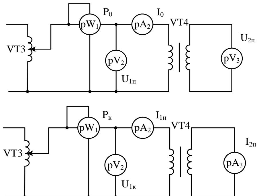
По результатам измерений построить внешнюю характеристику трансформатора для различных значений коэффициента загрузки трансформатора.
