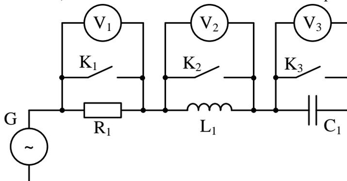
По результатам измерений и вычислений построить векторные диаграммы токов и напряжений, треугольники сопротивлений для каждого опыта.
