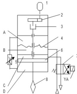
21 Определить, схема какой силовой головки показана на рисунке <:шлифовальная:>
