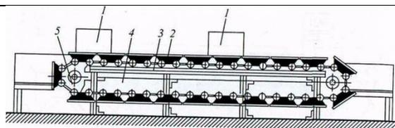
27 Определить какой конвейер показан на рисунке <:пластинчатый:>
