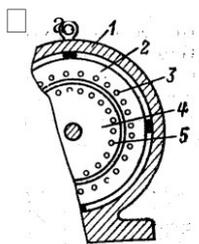
12. Относительная разность вращения магнитного поля статора и ротора называется - \_\_\_\_\_ (вставить пропущенное слово).
