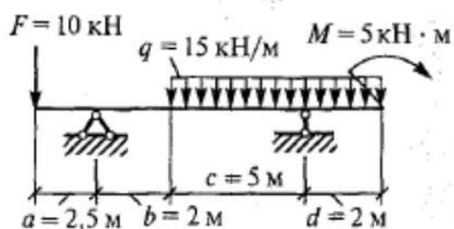
2. Построить эпюры поперечных сил и изгибающих моментов для консольной балки.
