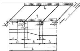
34 Расчетная схема рамы какого вагона показана на рисунке <:транспортер:>
