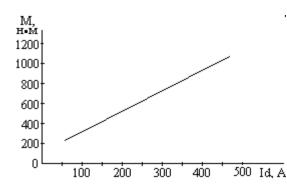
На рисунке показана электромеханическая характеристика ТЭД с независимым возбуждением при величине магнитного потока Ф=0,08 Вб. Рассчитать и построить аналогичную характеристику, если магнитный поток станет равным 0,09 Вб.
