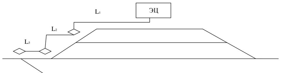
12. Посчитайте кабельную сеть станции по имеющимся данным:  $L_1 = 1000$  м,  $L_2 = 350$  м,  $L_3 = 40$  м.
