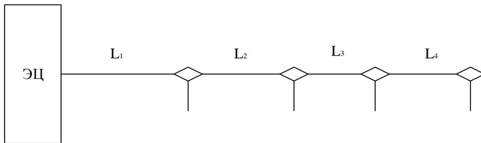
11. Посчитайте кабельную сеть станции по имеющимся данным:  $L_1 = 800$  м,  $L_2 = 350$  м,  $L_3 = 40$  м.
