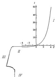
3. Свойство диода пропускать ток в прямом направлении, описывается следующим участком его ВАХ.
