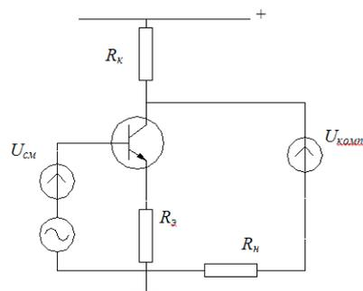
11. Для обеспечения работы n-p-n транзистора, подключенного по схеме с общим эмиттером, в нормальном активном режиме, базовый и коллекторный переходы должны быть подключены в следующих направлениях <.....>
