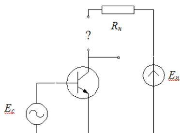
8. На принципиальной схеме усилительного каскада с общим эмиттером при монтаже пропущен элемент:
