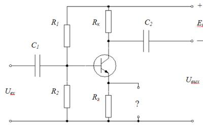
9. На рисунке приведена схема для графического расчета каскада с общим эмиттером. В качестве рабочей точки какую точку выберет экспериментатор. <.....>
