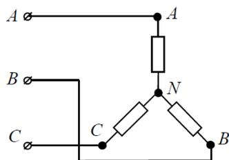
1. напряжение  $U_{AN}$  – линейное, а напряжение  $U_{BN}$  – фазное
