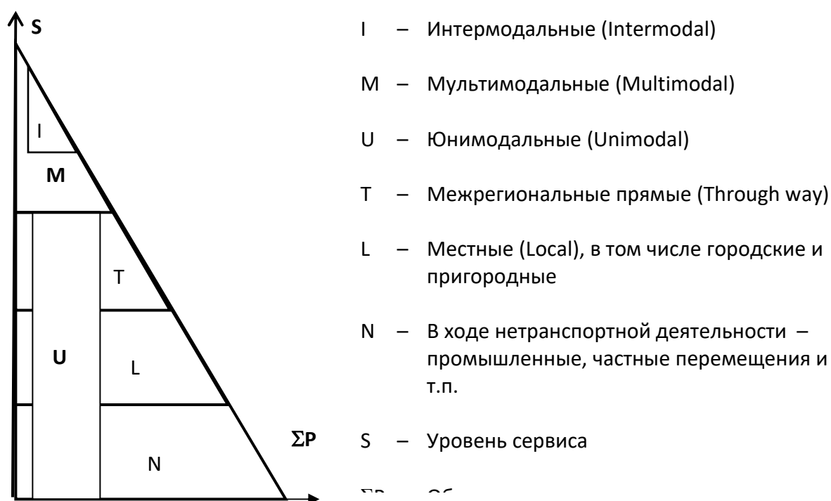
Рисунок 1 Иерархическая структура систем доставки
