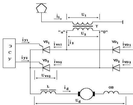
Как известно, действующее значение ЭДС вторичной обмотки трансформатора  $E_2$  связано с его амплитудным значением:
