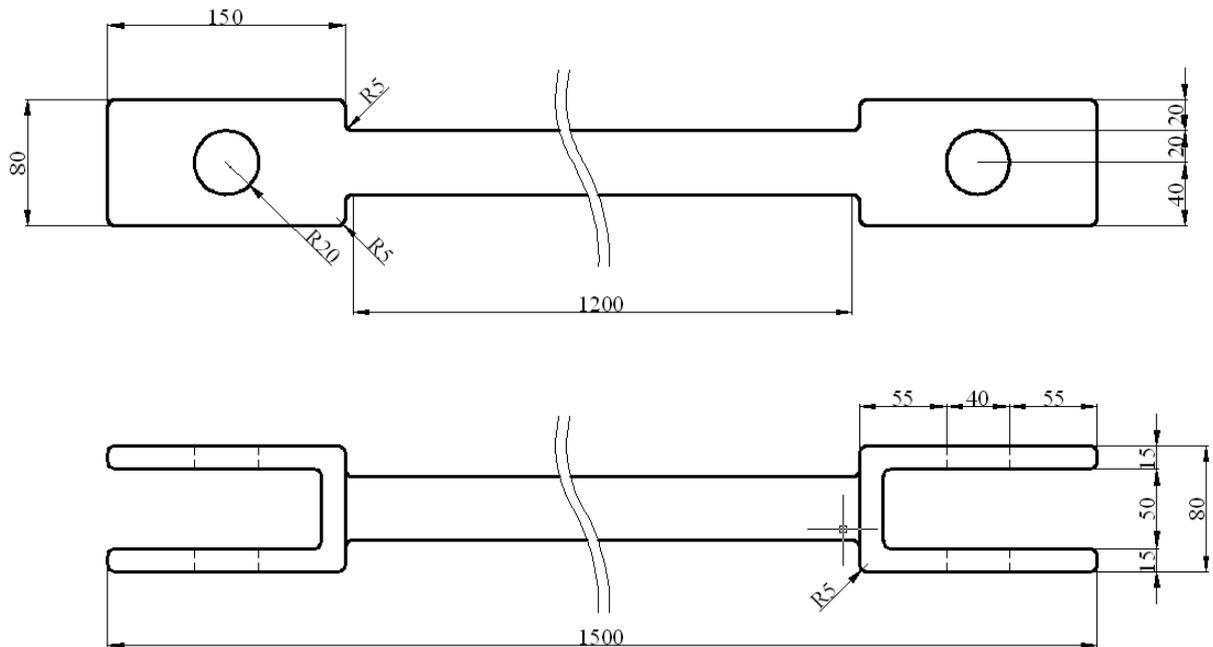
**Задание 3.** Произвести расчет на прочность прутковой В-образной клеммы промежуточного рельсового скрепления. Момент затяжки закладного болта соответствует нормативному и равен 200 Н\*м.
