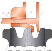
Назовите, какое измерение при помощи ПШВ показано на рисунке ширину желобов в \_\_\_\_\_
