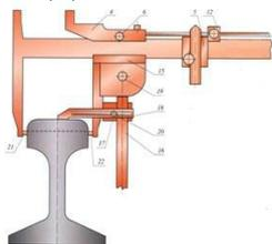
Назовите, какое измерение при помощи ПШВ показано на рисунке, \_\_\_\_\_ износ рельса
