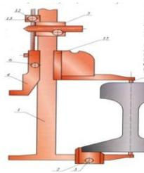
Назовите, какое измерение при помощи ПШВ показано на рисунке \_\_\_\_\_ износ головки рельса
