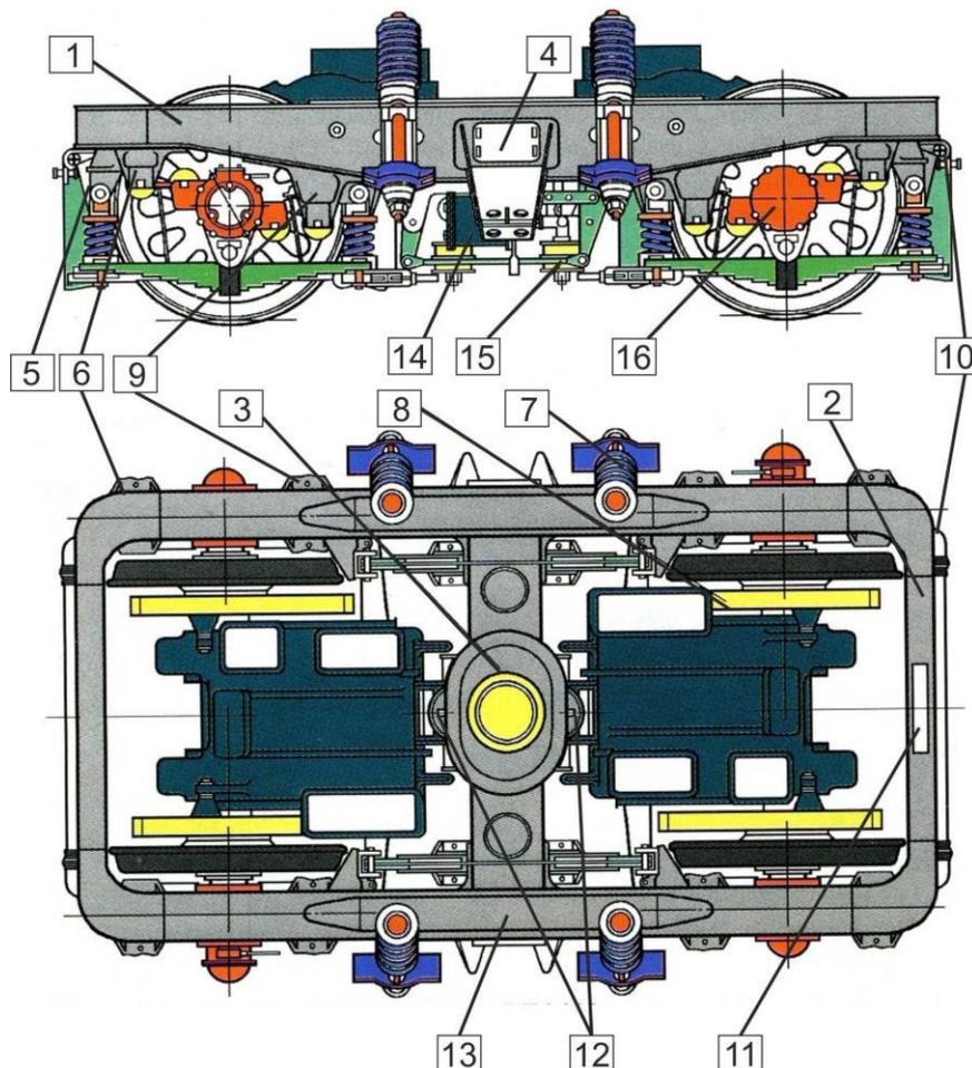
2. Необрессоренная масса тележки 11 т, обрессоренная масса тележки – 11 т. Эквивалентная жесткость рессорного комплекта, приходящаяся на 1 колесо, 1010 кН/м.
