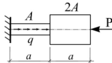
14. Стержень испытывает вид деформированного состояния ...
