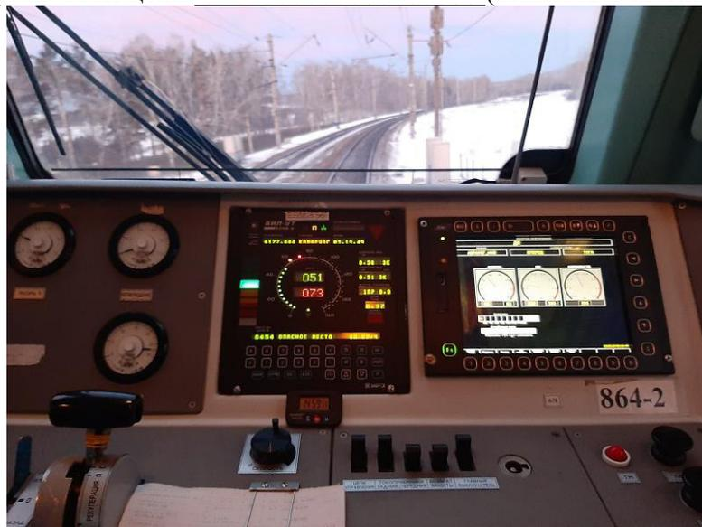
15. Дополните. На рисунке представлено блок индикации локомотивный, входящий в состав \_\_\_\_\_ (записать в именительном падеже аббревиатуру).
