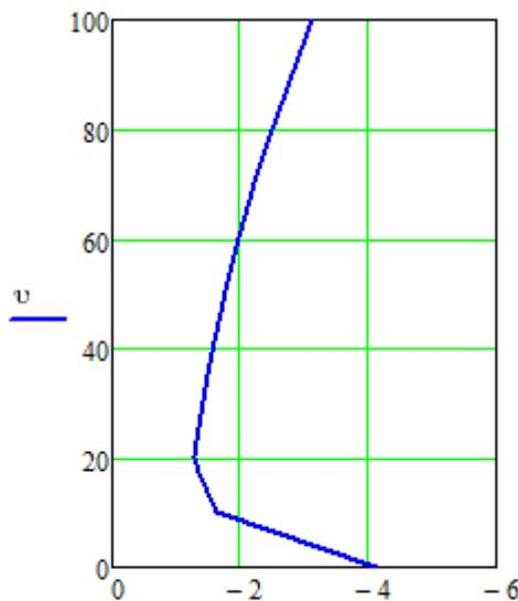
В) удельная равнодействующая сила на поезд в режиме торможения
