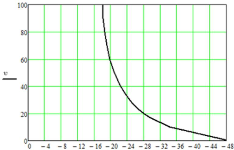
А) удельная равнодействующая сила на поезд в режиме тяги
