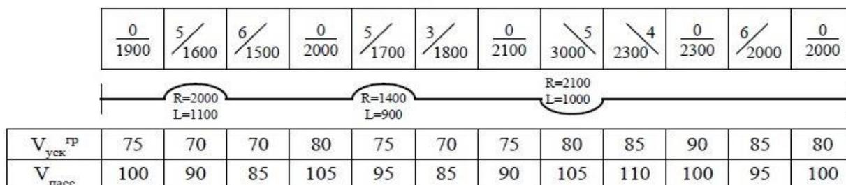
Посчитать пропускную способность перегона и определить необходимость модернизации действующих устройств интервального регулирования движения поездов.
