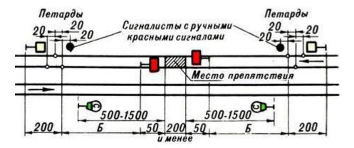
3. Начертить схему ограждения внезапно возникшего препятствия на перегоне и отсутствии необходимых переносных сигналов.
