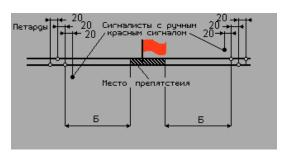
4. Начертить схему ограждения на станционном железнодорожном пути места препятствия.
