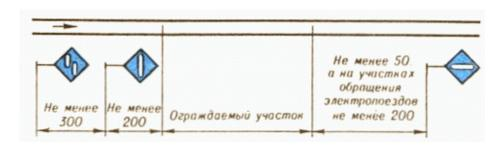
7. Начертить схему установки сигнальных указателей «Опустить токоприемник» и постоянных сигнальных знаков «Поднять токоприемник» и «Внимание! Токораздел» на железнодорожных путях общего пользования.
