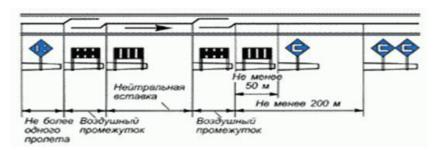
6. Начертить схему установки предупредительные временных сигнальных знаков, в местах, не допускающих проследования электроподвижного состава с поднятыми токоприемниками.
