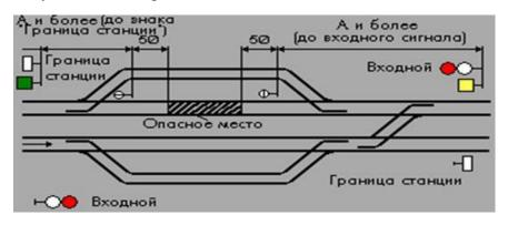
2. Начертить схему ограждения опасного места расположенного на одном из путей двухпутного перегона.
