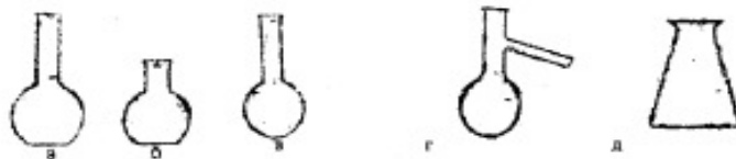
Рис. 3. Колбы: а, б – плоскодонные; в – круглодонная; г – колба Вюрца; д – коническая
