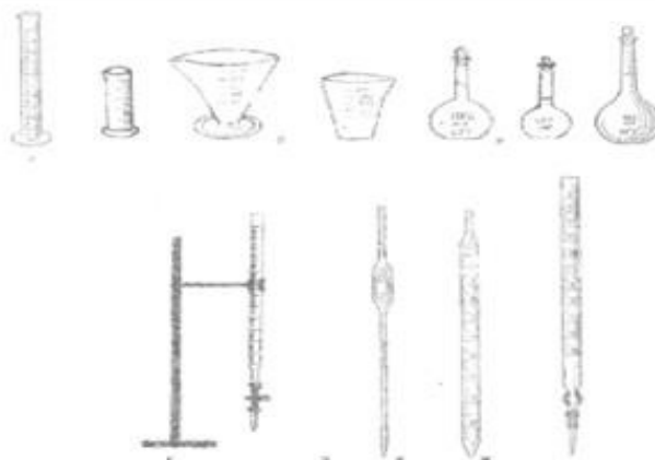
Рис. 7. Мерная посуда: а – мерные цилиндры; б – мензурка; в – мерные стаканы; г, ж – бюретки с различными затворами; д – обобщенная пипетка; е – градуированная пипетка
