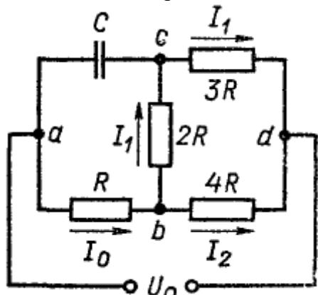
Решение. Постоянный ток через конденсатор не проходит. Чтобы определить заряд на конденсаторе, нужно найти разность потенциалов на его обкладках равное разности потенциалов  $U_{ac}$  между точками а и с, равной в свою очередь сумме падений напряжений на резисторах сопротивлением  $R$  и  $2R$ , которое, в свою очередь, равно
