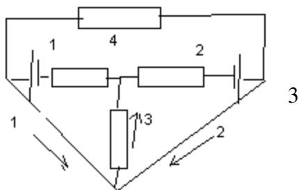
$$1\text{-Нижний узел} \quad I_1 + I_2 - I_3 = 0$$
