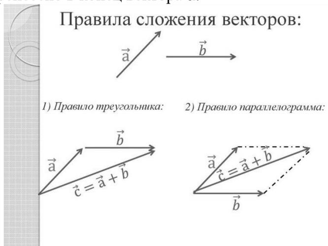
Правило ломанной: последовательно соединяем вектора. Вектор суммы – это вектор идущий из начала движения в конец движения.
