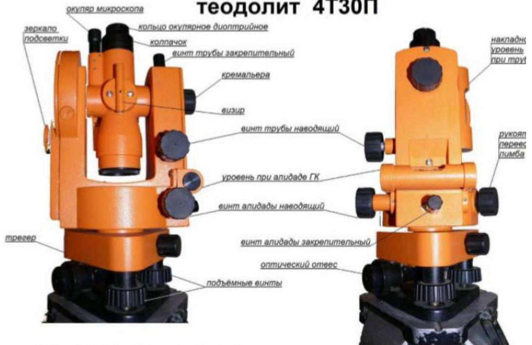
Рисунок 1. Устройство теодолита
