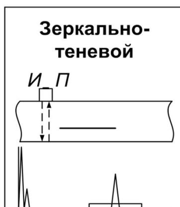
Рисунок 2 – Схема зеркально-теневого метода ультразвукового контроля
