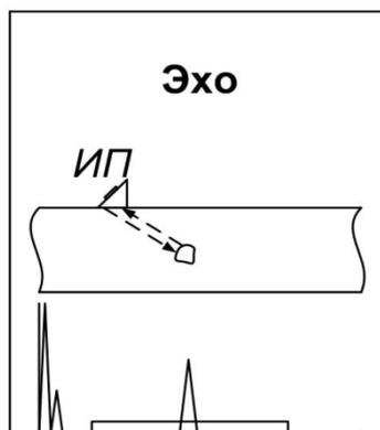
Рисунок 1 – Схема эхо-импульсного метода ультразвукового контроля
