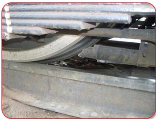
колеса с рельсом, а форсунки отрегулированы на подачу песка производительностью 400-700 г/мин песка на ось летом и 900-1500 г/мин в зимний период. Регулировка рассчитана на передние по ходу колесные пары локомотива, т.к. песок, подаваемый под колесные пары, частично остается на рельсах после прохождения первой колесной пары, оставшегося количества песка достаточно для сцепления с рельсами остальных колесных пар.
