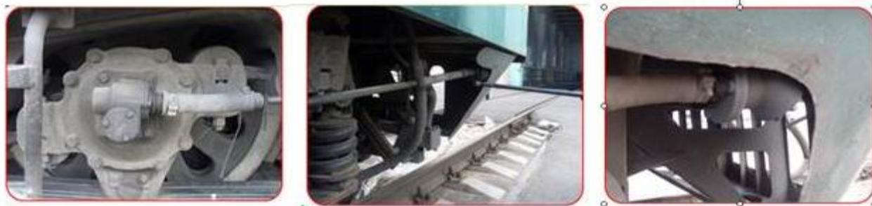
Осматривают нижние люки тяговых двигателей и крепление межкузовных и шапочных болтов простукиванием и визуально. Кожуховые люки должны быть закрыты и через них не должна выходить смазка, ее определяют по наличию потеков масла через люки или через соединения кожухов. Люки кожухов и тяговых двигателей должны быть закрыты.
