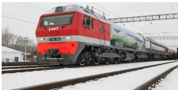
редача: газотурбинный двигатель соединён с генератором, а вырабатываемый таким образом ток подаётся на электродвигатели, которые и приводят локомотив в движение.
