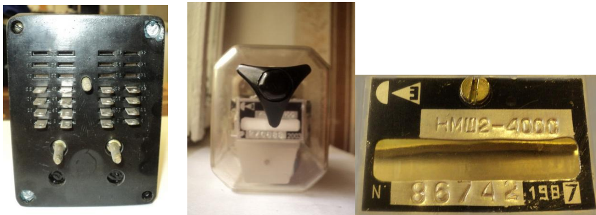
Рис.1. Монтажная, лицевая сторона и маркировка завода изготовителя реле НМШ2-4000
