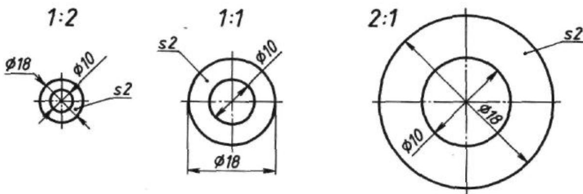
Рисунок 5 – Чертежи шайбы, выполненные в разных масштабах
