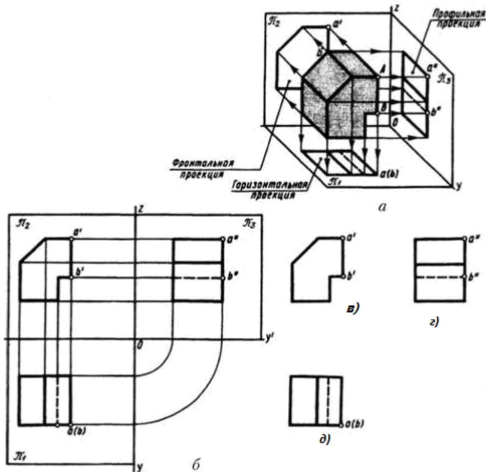
Рисунок 10- Получение комплексного чертежа
