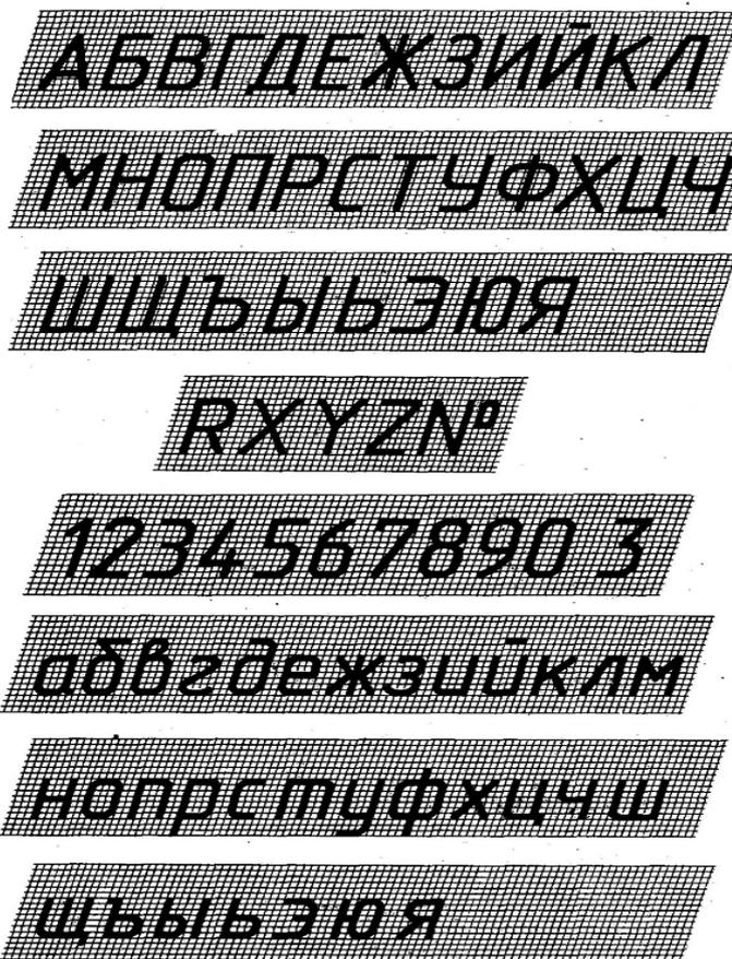
Рисунок 6-Шрифт 10 тип Б с наклоном 75°
