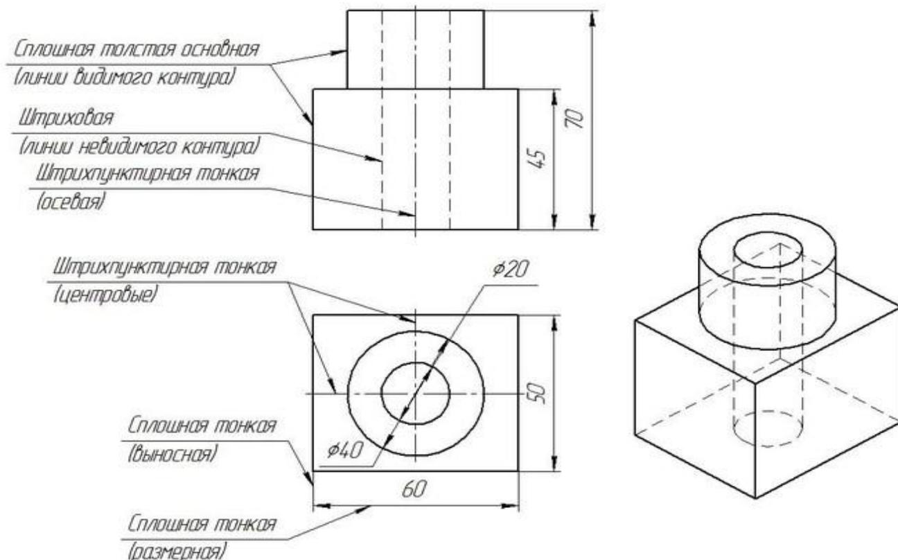
Рисунок 4 - Линии чертежа
