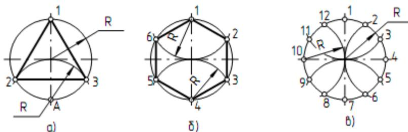
Рисунок 7- Деление окружности на равные части
