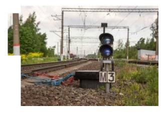
Устанавливаются карликовые светофоры со гласно проекта, как правило, с правой стороны в направлении движения поездов. Установка карликового светофора выполняется или над осью ограждаемого пути, или над осью междупутья. Места установки определяются исходя из схематического плана станции.
